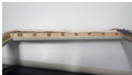
Figura 61 – Lasers fixados no Quadro
