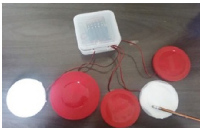
Figura 49 – Bateria digital utilizando tampas de plástico
