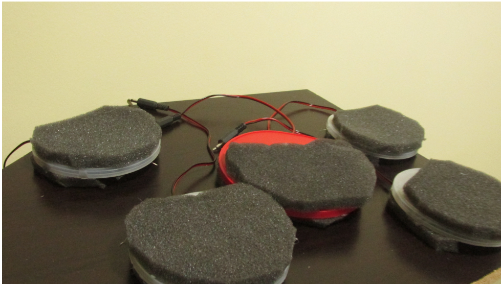
Figura 54 – Bateria com tampas de plástico e espumas
