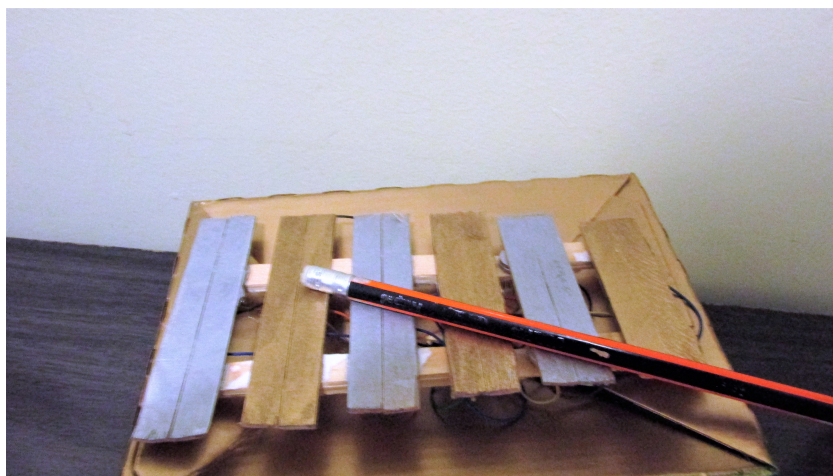
Figura 52 – Xilofone com piezoelétrico e palitos de madeira
